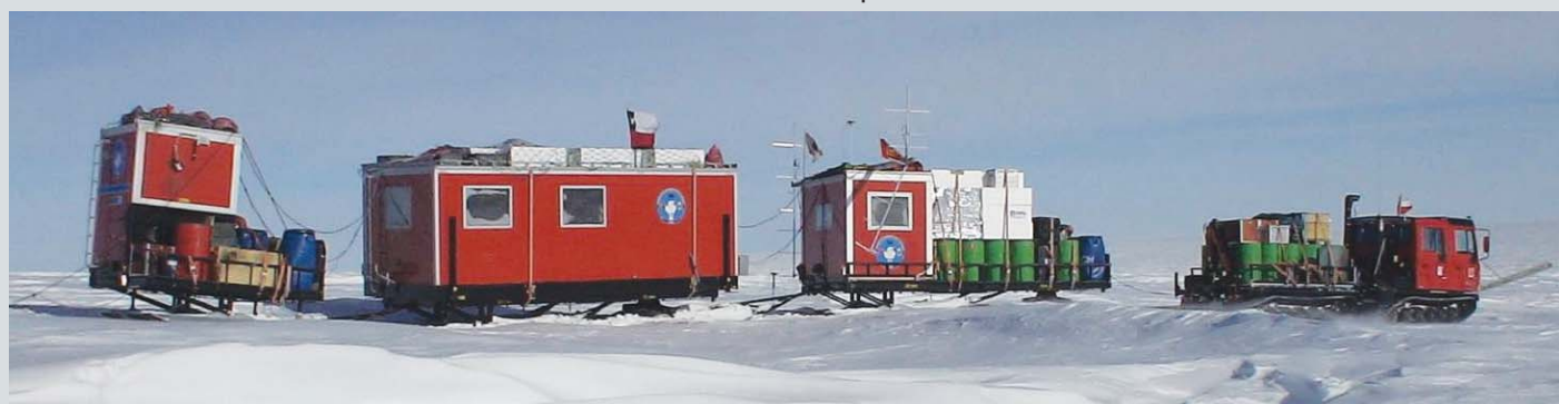
Fig. 2. Convoy expedicionario en el plateau polar. De derecha a izquierda el tractor Berco TL-6, el trineo el módulo de radar/GPS y carga, el trineo con el módulo habitación principal y el trineo con el baño y el equipo generador.
